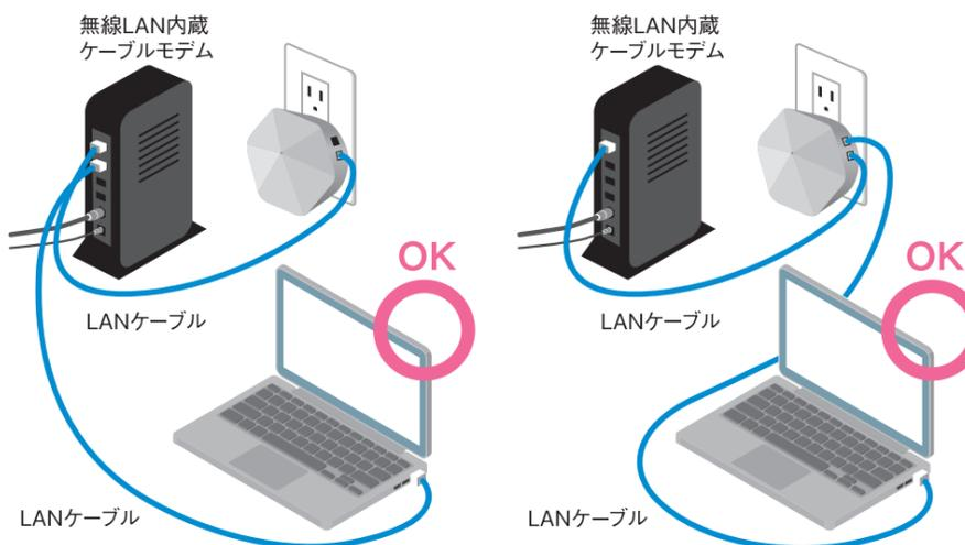
無線LAN内蔵ケーブルモデムと接続されているポッドにパソコンやSTB (セットトップボックス) などを接続する場合はどちらのLANポートに挿しても接続可能です。ケーブルモデムとポッドの間に市販ルーターを接続しないでください。
