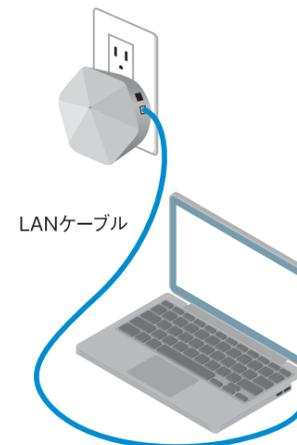
もう一台のポッド付近でパソコンやSTB (セットトップボックス) などを有線 (LANケーブル) で接続する場合はポッドへ直接、接続してください。
