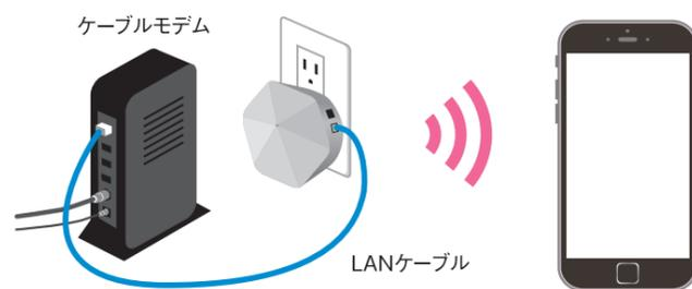
ケーブルモデムとポッドを有線 (LANケーブル) で接続してください。ポッドのLANポートはどちらも接続可能です。
